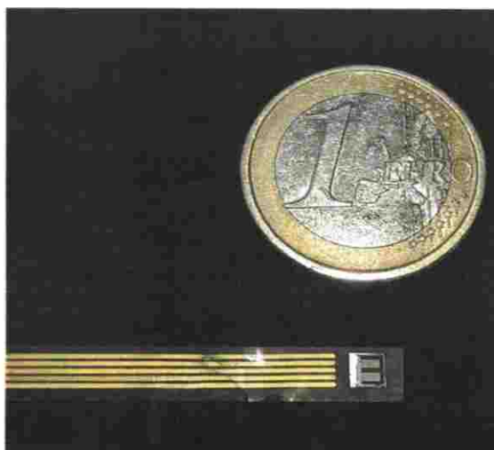
El chip que incorpora el biosensor mide 3x3 mm
